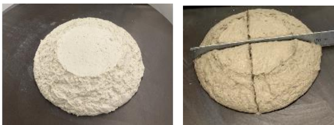
図-3.5 TF 試験後の試料土【左:カオリン(w=80%), 右:木節粘土(w=50%)】
