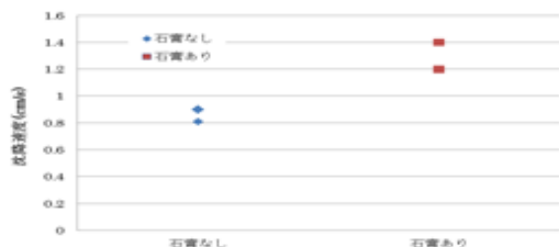
図 2.2 石膏添加の有無と沈降速度の関係
