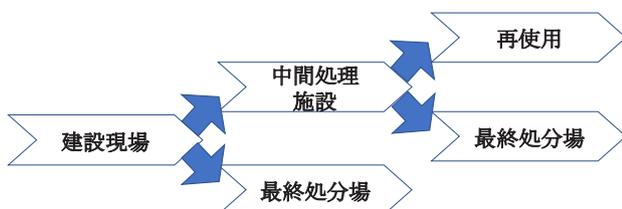
図 1 建設汚泥の中間処理、最終処分プロセス
