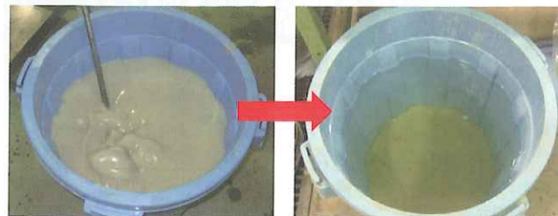
分離剤添加前 分離剤添加後の分離状況 写真-3 サブリ安定液の産廃処分減量化
