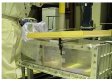
図-3(a) 空中落下法による地盤作製
