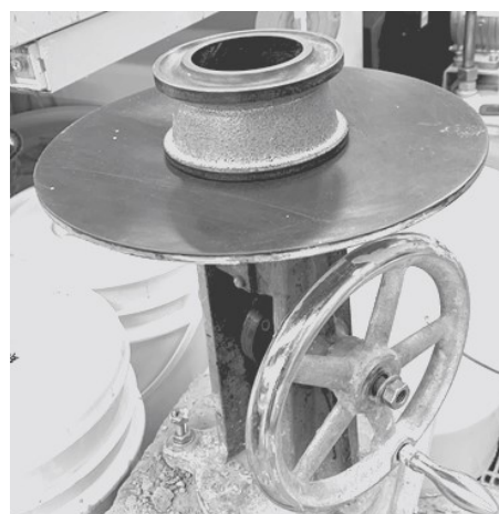
図-2 テーブルフロー試験装置
