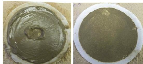
写真-3 ろ紙に付着した各安定液の泥膜形成状況
