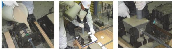
1)安定液充てん 2)コンクリートの打設 3)コンクリートの置換完了
