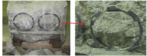
写真-2 コンクリート置換充填状況
