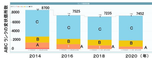
図-5 ある路線の C ランク以上変状数最近の経年変化結果 8)
