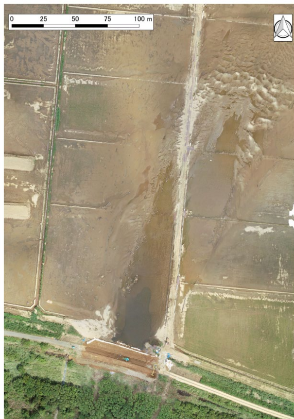
図-8 UAV のデータから作成したオルソ画像の例 (高瀬川)
