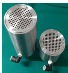
図-2 内部侵食試験用に改造したペダスタルとキャップ
