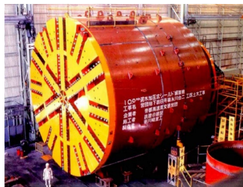
写真-2 氷川台駅付近泥水式シールド機 5)
