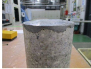
図-3 モルタルによるキャッピング
