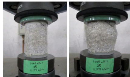
図-8 一軸圧縮試験時の様子
