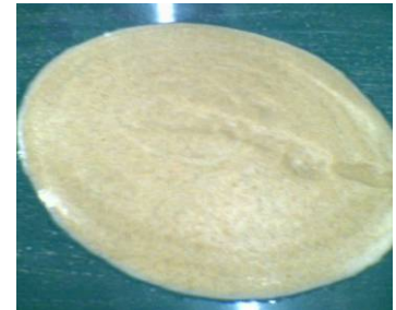
写真-2 気泡混合土
