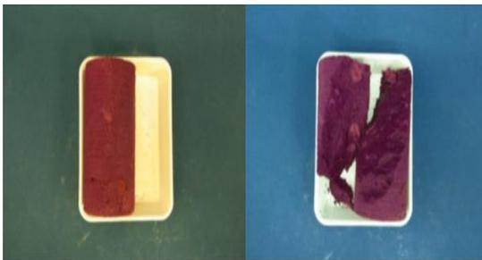
図 2.1 気泡有り工法のコアサンプル(左:外部, 右:内部)
