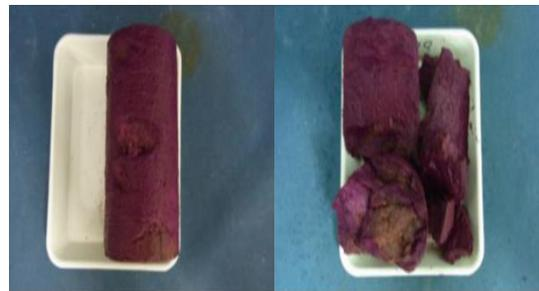
図 2.2 気泡無し工法のコアサンプル(左:外部, 右:内部)
