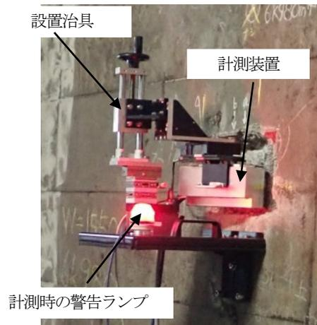
図-6 X線回折法による計測状況
